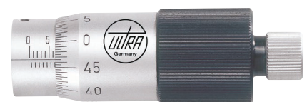
Ableseung 0,005mm, Spindelsteigung 0,5mm (100 Teilstriche auf der Trommel)
