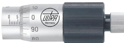
Ableseung 0,01mm, Spindelsteigung 1,0mm (100 Teilstriche auf der Trommel, Ableseung ohne Addition)
