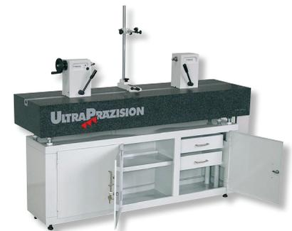
Rundlaufprüfgerät mit Hartgesteinbasis,
