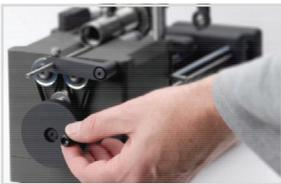
Antrieb durch seitliches Handrad
