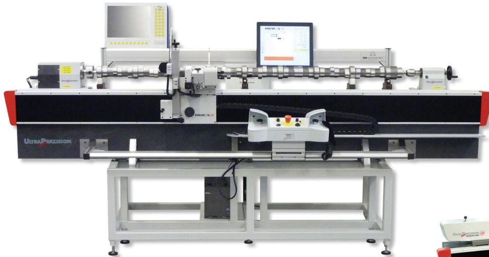
Das multifunktionale Messzentrum ist für fast alle rotations-symmetrischen Bauteile geeignet, es ersetzt eine Vielzahl von klassischen Handmessmitteln im Fertigungsbereich. Das Messzentrum wird für Ihr spezielles Teilespektrum angepasst, Werkstücklängen bis 2500mm wurden bereits realisiert.
