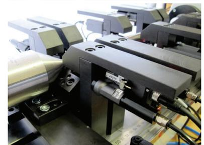
Mehrstellenmessvorrichtung für Präzisionswellen
