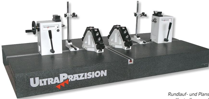
*Rundlaufprüfvorrichtung mit Hartgesteinbasis zur Kontrolle von schweren Motorwellen zwischen Spitzen, Lastaufnahme durch zusätzliche Rollenböcke.*
