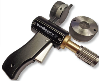
Kombo-Verzahnungslehrrörde mit Messuhr (analog oder digital) zum Prüfen der effektiven und tatsächlichen Zahnflächenbreite an Werkstücken mit Innenverzahnung. Combo spline plug gauges with dial gauge (analogue or digital) for checking effective and actual circular space width on internal splined work pieces.
