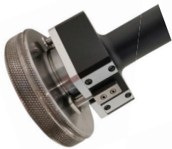
Digital-Schnellmessgeräte für Außen- und Innenmessung von Ø 20-300mm / Messweg 5mm
