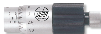
Ablesung 0,005mm, Spindelsteigung 0,5mm (100 Teilstriche auf der Trommel)
