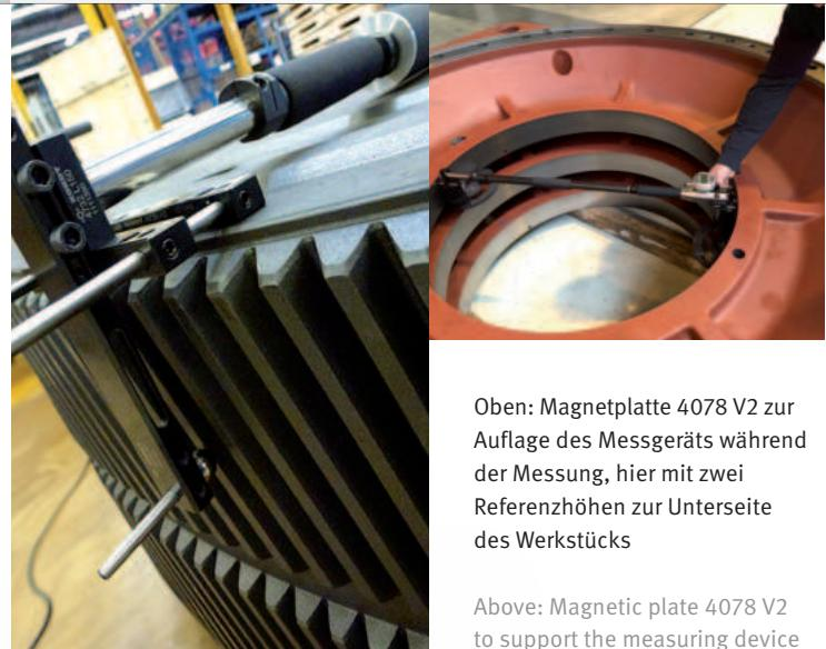
Oben: Magnetplatte 4078 V2 zur Auflage des Messgeräts während der Messung, hier mit zwei Referenzhöhen zur Unterseite des Werkstücks
