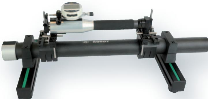
Links: Das Messgerät wird auf die Messaufgabe passend eingestellt. CORDASfix verfügt über entsprechende Anschläge.
